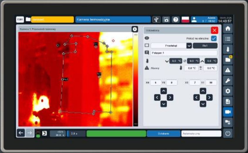
Wykorzystanie kamer termowizyjnych do wizualnej kontroli elementów formowanych wtryskowo i narzędzi
